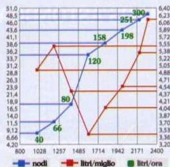
Velocità e consumi indicati nel grafico sono stati forniti direttamente dal cantiere sulla base delle prove effettuate in mare, ma il consumo reale potrà discostarsi dai dati pubblicati in funzione del carico imbarcato e della sua posizione, delle condizioni di uso dell'unità, della messa a punto e dello stato dei motori stessi, oltre che dalle caratteristiche delle eliche utilizzate.
